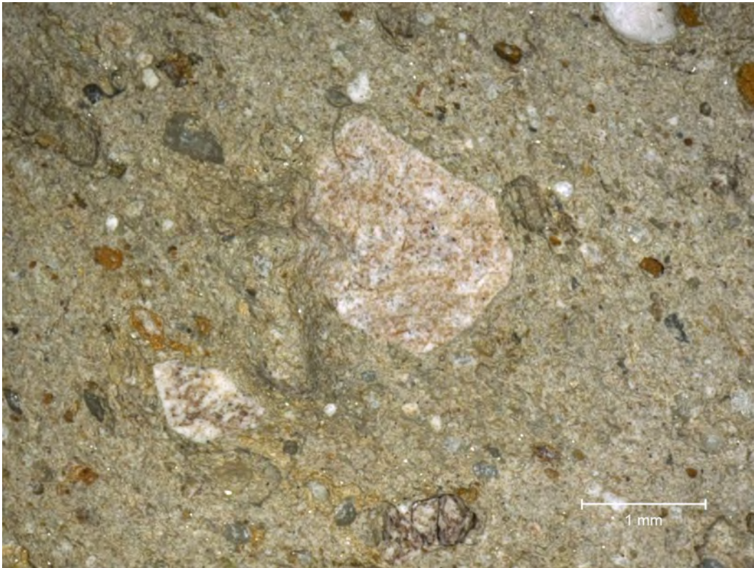
Bild 7/FK 02: Einschluss eines fraglichen Feldspat-Kristalls
