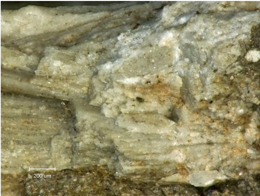
Bild 7/FK 05: Detail des Calcit-Aggregats
