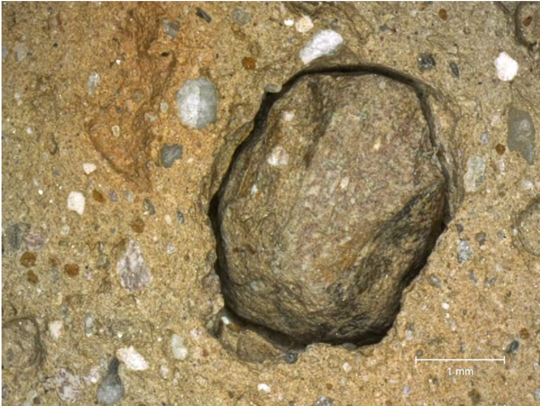
Bild 5/FK 02: Starke Schwindung eines Korns.
