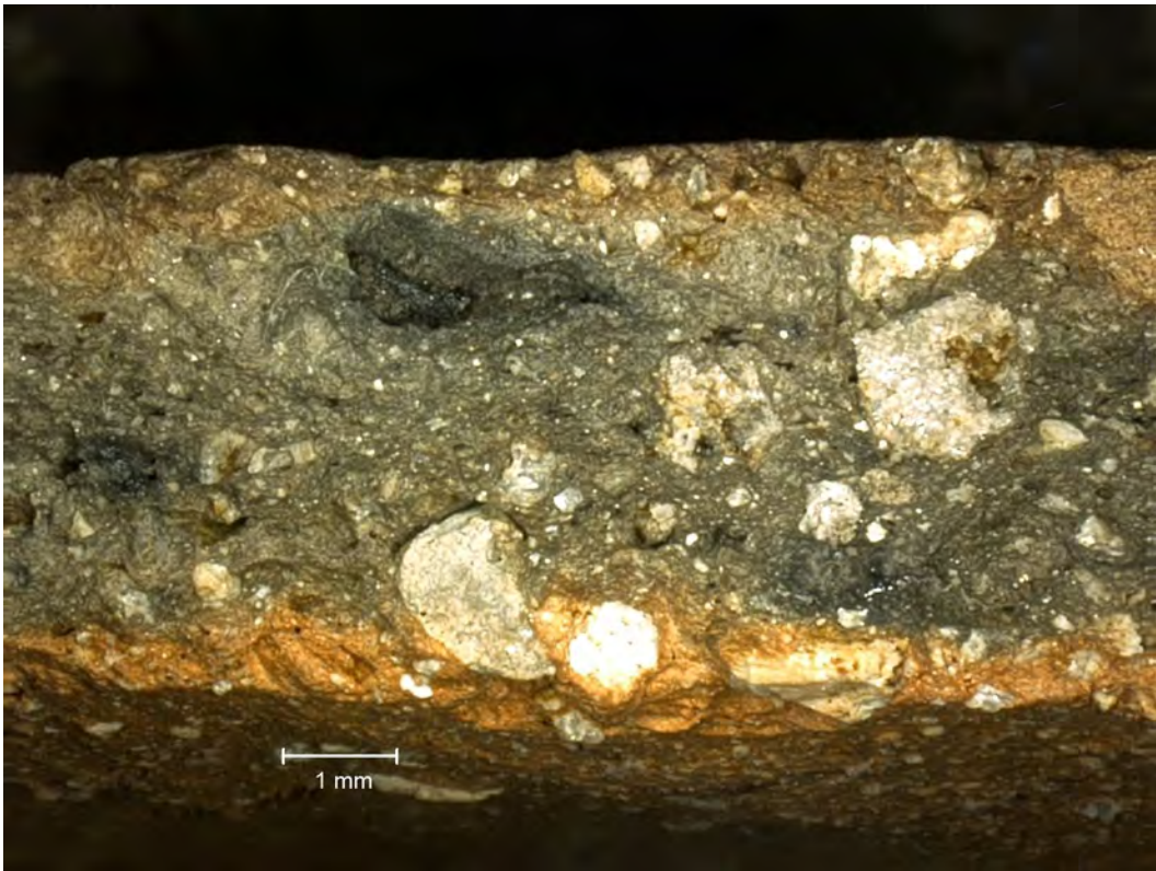
Bild 3/ FK 05: Querbruch. Die hellen Partikel sind Calcit.
