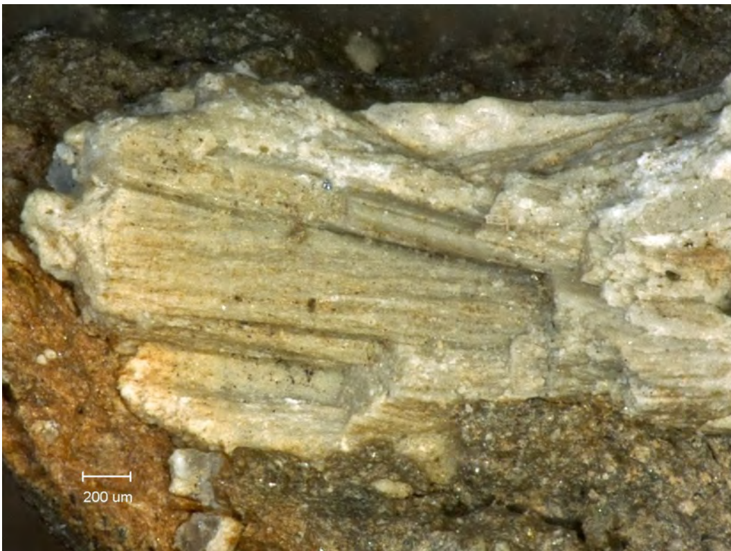
Bild 6/FK 05: Großes Calcit-Aggregat, radialstrahliger Aufbau, kein Feinbau
