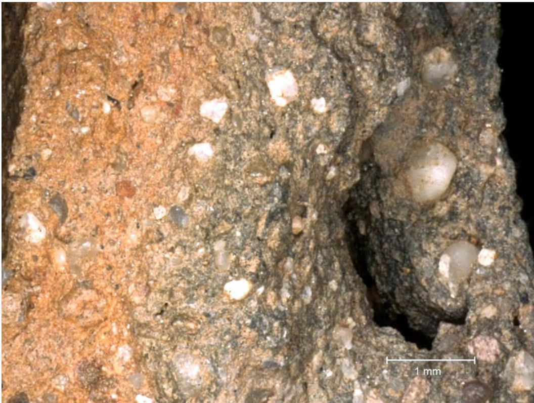
Bild 7/FK 03: Querbruch. Erkennbar sind Blasenbildung und grobes Korn
