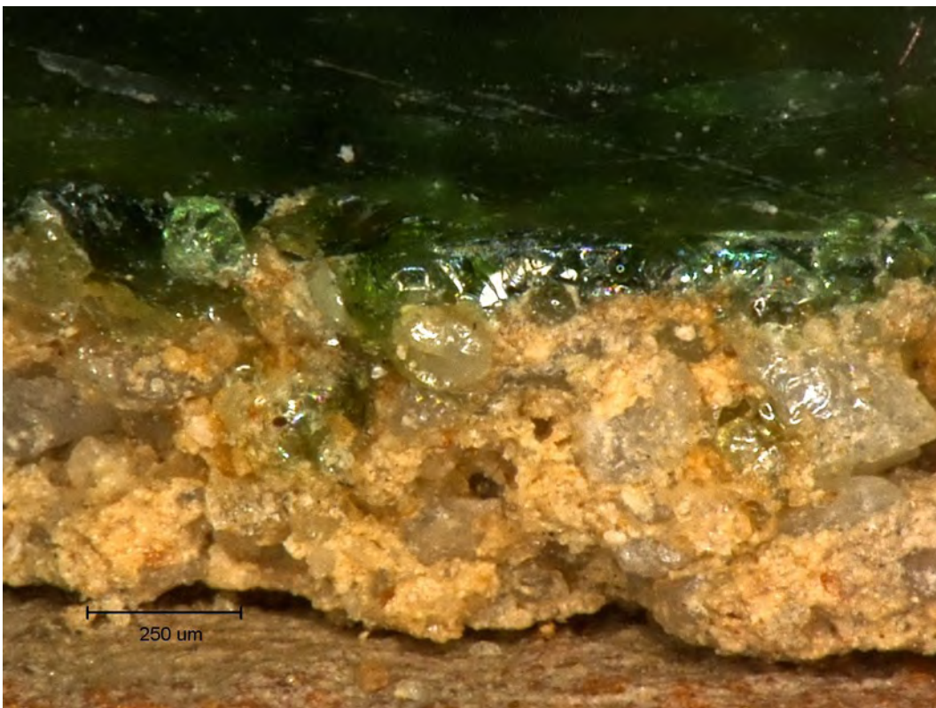
Bild 6/FK 04: Unterschicht der Glasur, grob aber eisenarm
