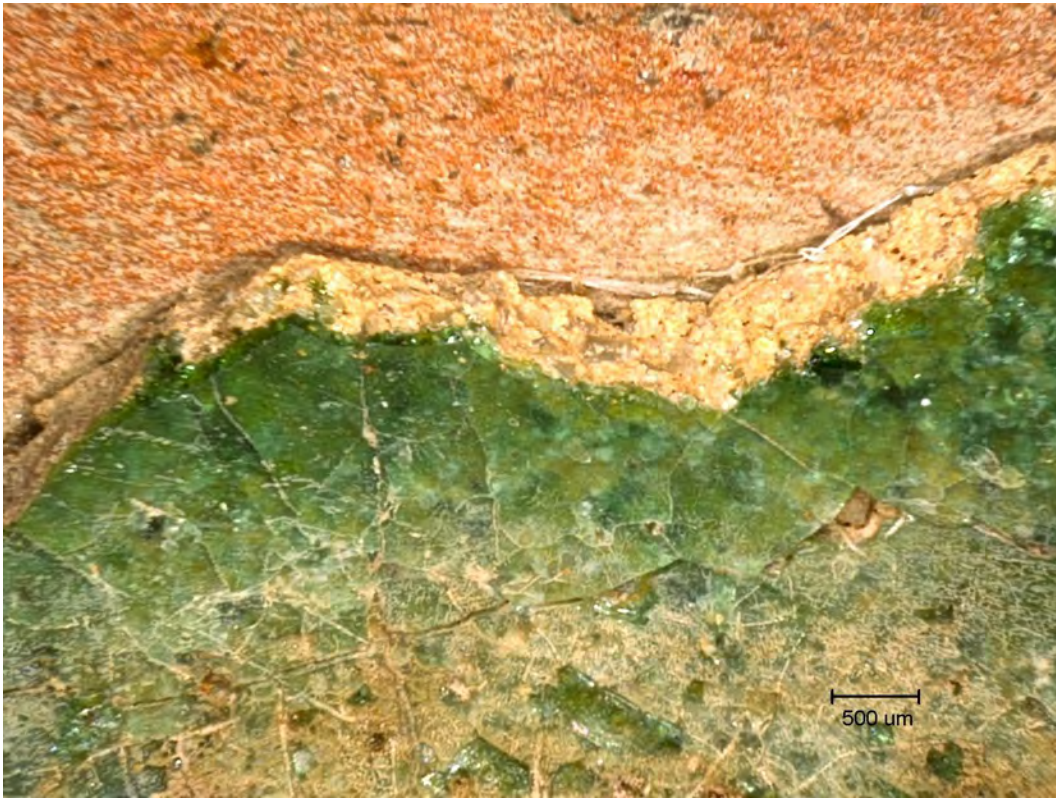
Bild 1/FK 04: Innenseite (?), Glasur mit Unterschicht, Irdengut
