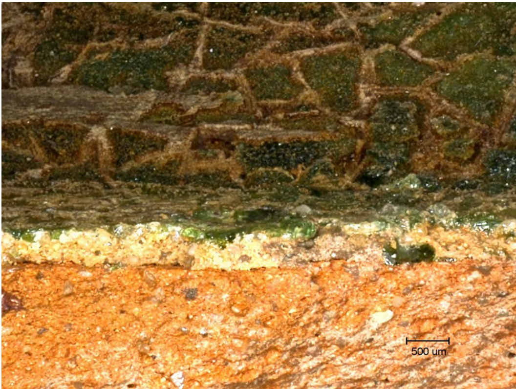
Bild 3/FK 04: Aufnahme schräg zum Querbruch, Glasur, Unterschicht, Irdengut
