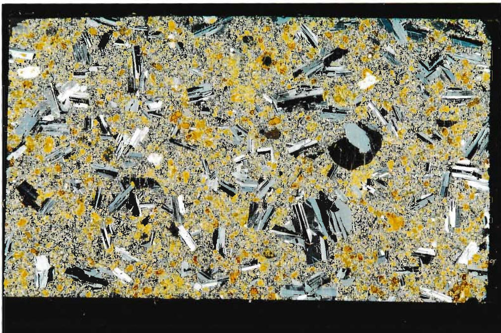
Abb. 29: Latiandesit Typ Idar (Navit); Decke III (NW-Scholle), Decke IX & XI (SE-Scholle); bis zu 7 mm große Plagioklas-Agglomerationen; Iddingsit-Pseudomorphosen nach Olivin; 2 Nicols; Vergrößerung 10:1; Nr. 53.
