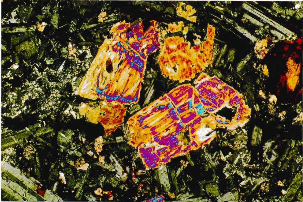
Abb. 33: Zwei schöne Talk-Pseudomorphosen nach Ortho-Pyroxen mit gerader Auslöschung; gut zu erkennen ist die 2. Generation der Plagioklas-Einsprenglinge; links eine Iddingsit-Pseudomorphose nach Olivin; 2 Nicols; Vergrößerung 92:1; Nr. 1851.
