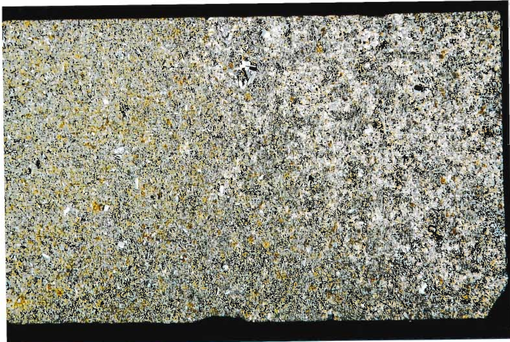
Abb. 19: Latiandesit Typ Steinkaulenberg. Decke I (NW-Scholle), Decke III (SE-Scholle); wenige, agglomerierte Plagioklas-Einsprenglinge in einer dichten Grundmasse; 2 Nicols; Vergrößerung 10:1, Nr. 2237.
