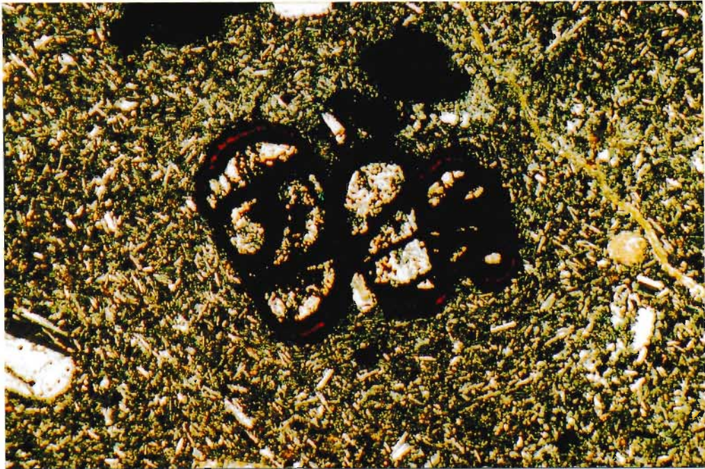
Abb. 28: Beginnende Iddingsit-Bildung nach vollständiger Serpentinisierung der Olivine; eine endgültige Iddingsit-Pseudomorphose ist in Abbildung 29 und 30 zu sehen (Latiandesit Typ Göttenbach); 2 Nicols; Vergrößerung 42:1; Nr. 192.
