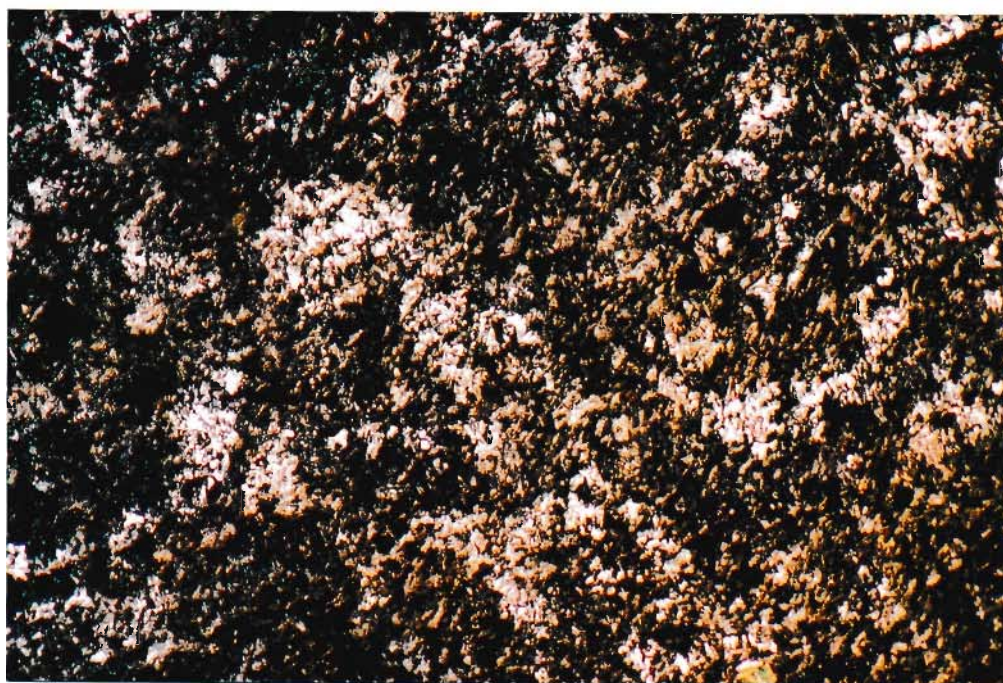
Abb. 21: Fortgeschrittene Verwitterung des Typ Rilchenberg; zu erkennen sind die Anlagen der Rilchenbildung; 92:1; Nr. 23.
