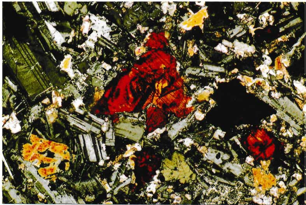
Abb. 30: Vollständig zu Iddingsit umgewandelte Olivine (Latiandesit Typ Idar); in dieser Decke sind alle Übergänge von Serpentinisierung zu vollständiger Iddingsit-Bildung zu finden; 2 Nicols; 92:1; Nr. 1881.
