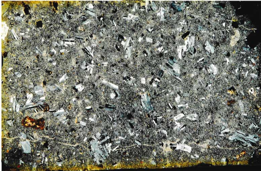
Abb. 27: Latiandesit Typ Göttenbach; Decke VIII (SE-Scholle); Plagioklas-Agglomerationen (bis 5 mm \phi ); Iddingsit-Pseudomorphosen nach Olivin; 2 Nicols; Vergrößerung 10:1; Nr. 192.
